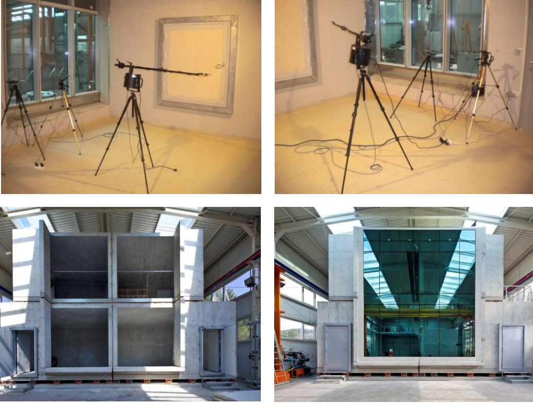
Şekil 6. ISO 10848-2 laboratuvarı düzeneğinin iç ve dış görüntüleri
