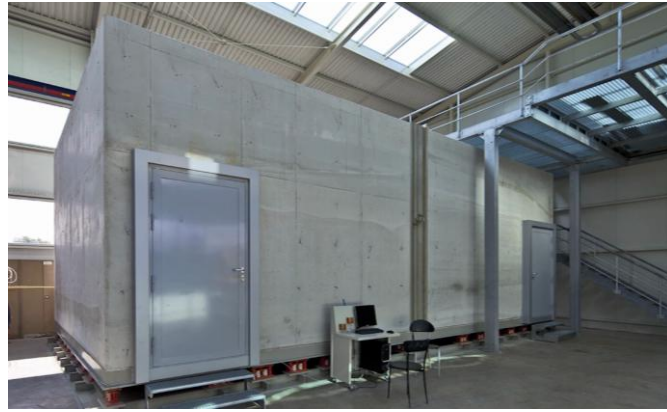
Şekil 3. ISO 10140-2 laboratuvarı düzeneğinin iç ve dış görünüşleri
