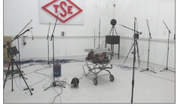
Şekil 4. Çınlama odasında gerçekleştirilen ses yutum katsayısı (sol) ve ses gücü düzeyi (sağ) ölçümlerine ilişkin fotoğraflar
