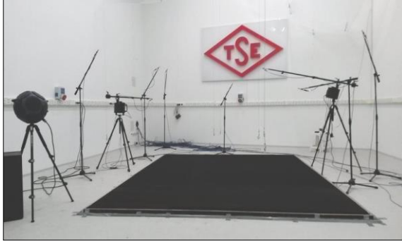
Şekil 4. Çınlama odasında gerçekleştirilen ses yutum katsayısı (sol) ve ses gücü düzeyi (sağ) ölçümlerine ilişkin fotoğraflar
